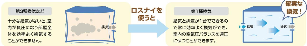
・【快適】熱交換換気により、室内の温湿度をある程度維持しながら換気できます。
