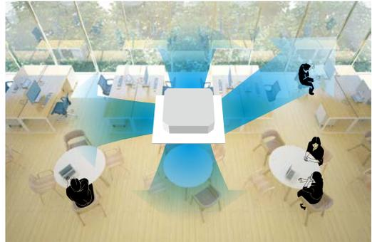
従来の上下ベーンに加え、左右ルーバーユニット(別売)の装着により、気流がいきとどきにくかったエリアにもきちんと風をとどけます。「人感ムーブアイ」との連動で温度ムラをよりすばやく解消し、風あて/風よけをより細かく制御できます。
