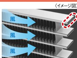
配管形状の扁平化により面積当たりの配管本数を増加させることで、熱交換性能が大幅に向上
