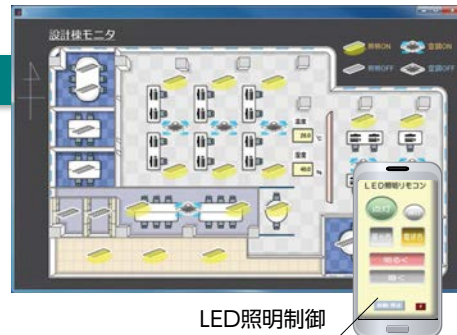
(空調照明運転モニタ)
