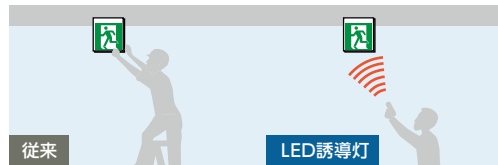
従来 高所に設置された誘導灯は、点検時に脚立などが必要です。 LED誘導灯 リモコン操作で自動点検をスタート。ラクラク点検が可能です。
