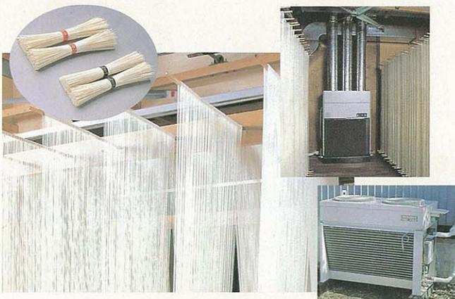
冷風除湿乾燥装置及び外気導入設備配置図例
