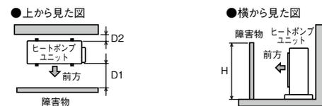
所要スペース(D1及びD2)は、障害物の高さ(H)によってわかります。風向ガイドを取り付ける場合は、下表を参照ください。ただし、設置条件によっては運転音が上がることがあります。
