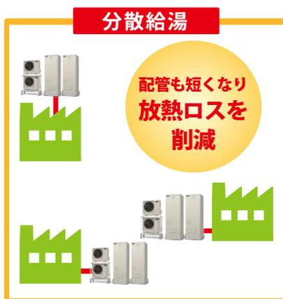
お湯を使用する箇所に給湯機を設置する分散給湯により配管放熱ロスを削減して、ランニングコストとCO<sub>2</sub>を削減することが可能。施設全体の給湯がストップするようなリスクを分散できるほか、ボイラー技士などの有資格者や法令点検が不要などのメリットも。
