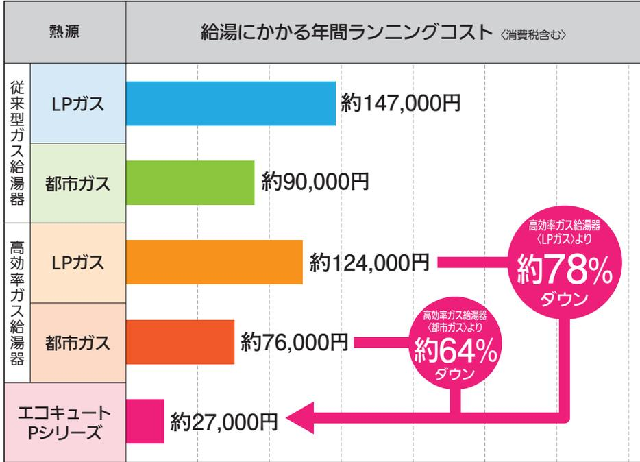
\*1日あたりの給湯・保温負荷はJIS C 9220の4人負荷を関西エリアの給水・外気温度に基づいて換算しています。
