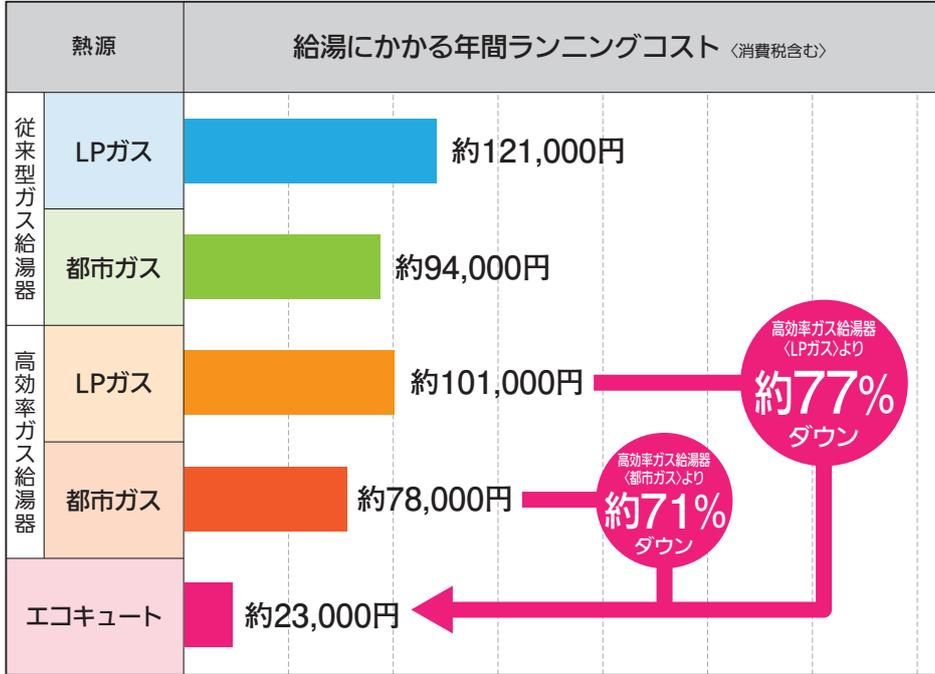
\*1日あたりの給湯・保温負荷はJIS C 9220の4人負荷を沖縄エリアの給水・外気温度に基づいて換算しています。
