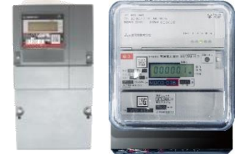
スマートメーター
