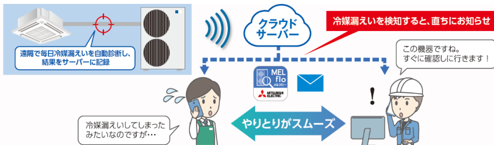
図2 冷媒漏えい検知機能のイメージ
