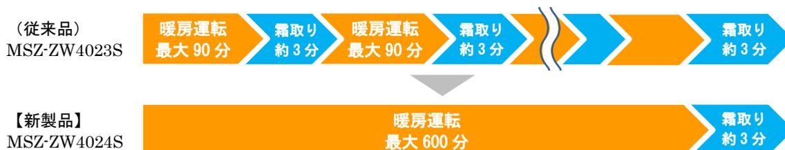
4. デュアルオンデフロスト回路を改良し、霜取り運転中も最高約 50℃温風を実現
